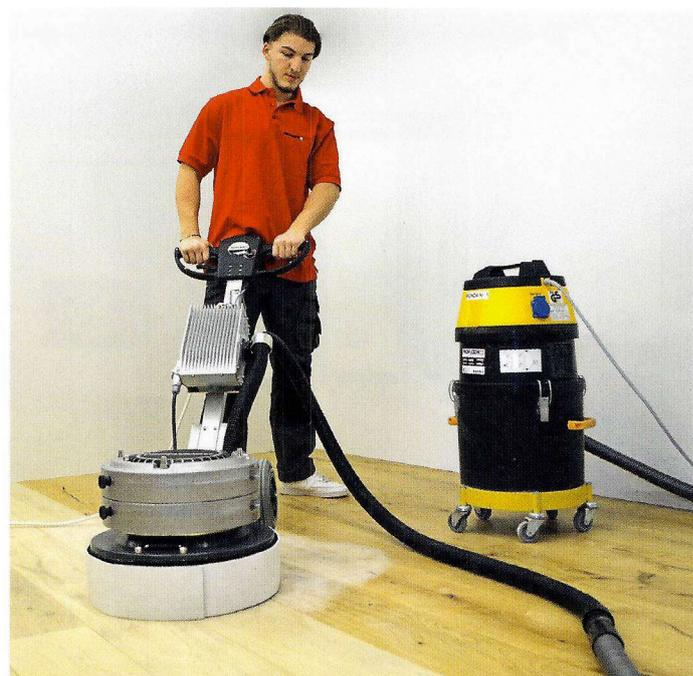
Die vielseitig einsetzbare Ein- und Dreischeibenmaschine „Profloor PF2200 VS – Toro“ kann die Bandschleif- sowie die einfache Einscheibenmaschine ersetzen.
